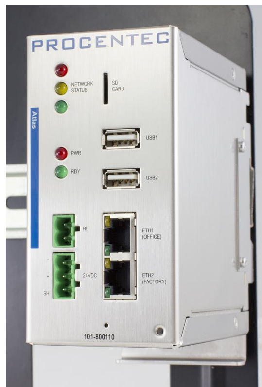
Abbildung 1 – Atlas auf einer 35 mm DIN-Schiene montiert
