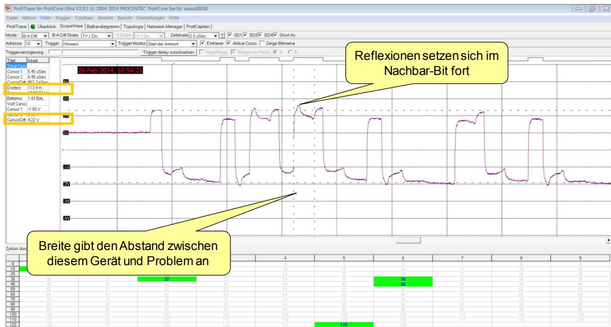
Abb. 37 – Fehlende Terminierung oder Kabelbruch (in der Nähe)
